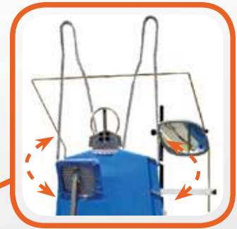
Coppia di telaietti maniche azionabili manualmente. Couple of sleeves frames with manual operating.
