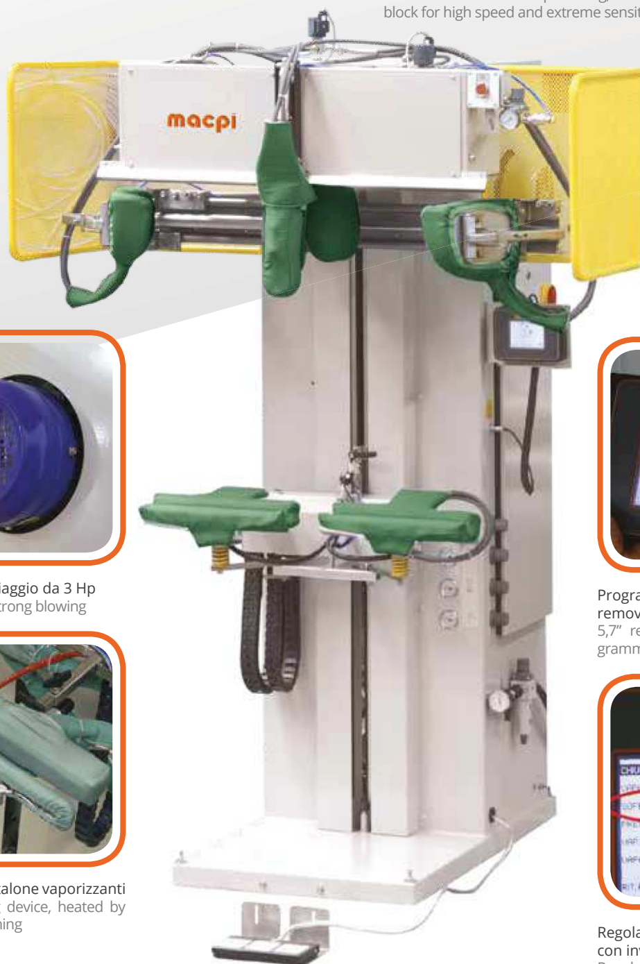
Dispositivo tensione bacino e gamba antistretch, con doppio cilindro per alta velocità e estrema sensibilità per tessuti elasticizzati e blocco meccanico.
