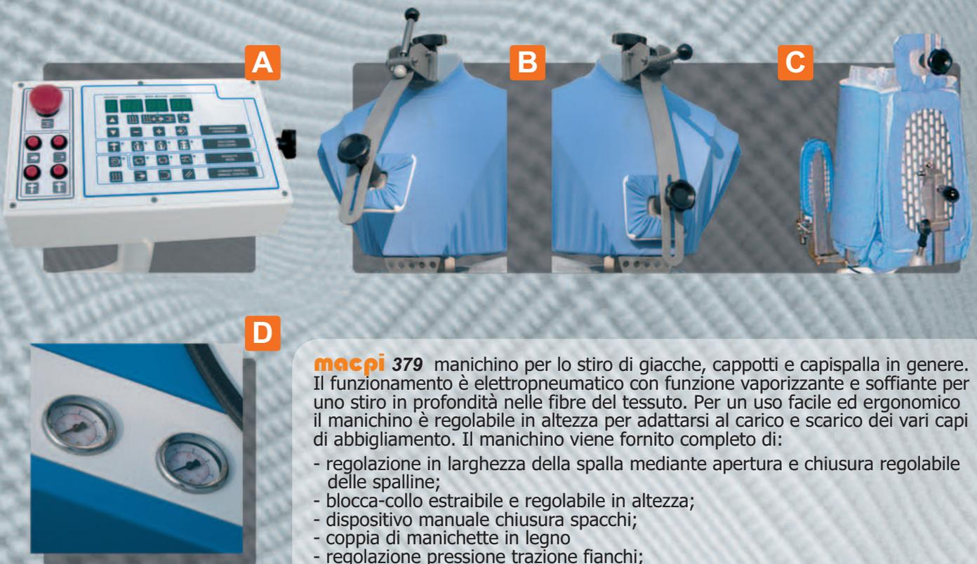
**macpi 379** manichino per lo stiro di giacche, cappotti e capispalla in genere. Il funzionamento è elettropneumatico con funzione vaporizzante e soffiante per uno stiro in profondità nelle fibre del tessuto. Per un uso facile ed ergonomico il manichino è regolabile in altezza per adattarsi al carico e scarico dei vari capi di abbigliamento. Il manichino viene fornito completo di:
