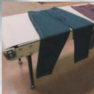
lo scarico automatico deposita i capi stirati su nastro trasportatore nelle modalità a pezzo singolo o con formazione di pacchi
