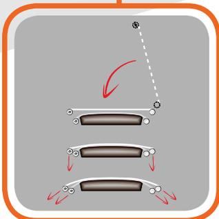
Funzionamento del pivot, che permette di ottenere una qualità superiore nello stiro gamba pantalone.
