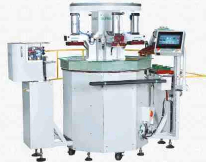
舒普全自动热转印机具有自动恒温设定，真空吸风装置，面料在压烫过程中不易走位；机械手自动上标，标识方位一致；气动恒压烫画受力均衡；机械手自动翻，机械手自动收料，自动计数，360度照明等功能。
