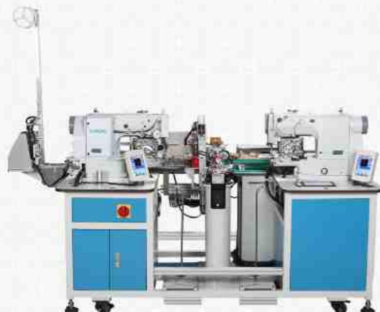
全程自动化操作，设备实现了自动送料、自动剪切、自动拼接、自动收料等，一人可同时操作两台机器，加工橡筋数量为7000条-8000条/8H。
